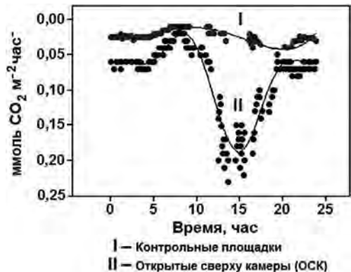
Рис. 4. Динамика скорости эмиссии CO 2 из контрольных площадок и ОСК в течение суток (средние данные за 15 дней).
