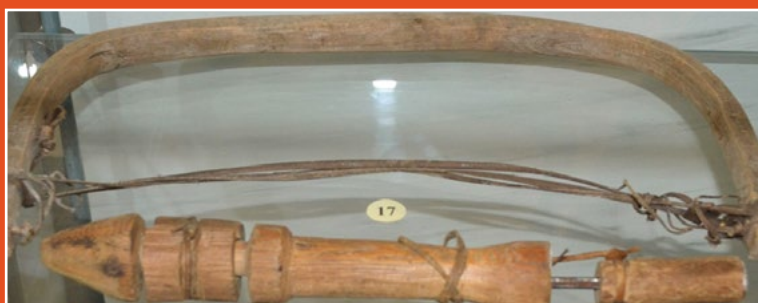
Лучок (приспособление для вращения сверла).
